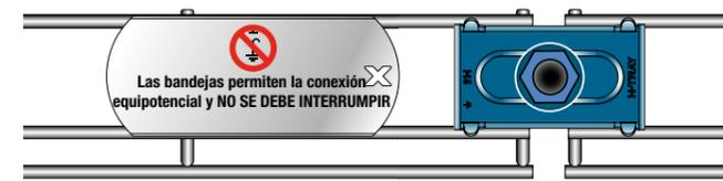
En algunas instalaciones, las bandejas portables necesitan estar conectadas equipotencialmente. Esto es para asegurar una conexión de protección o una conexión funcional.
